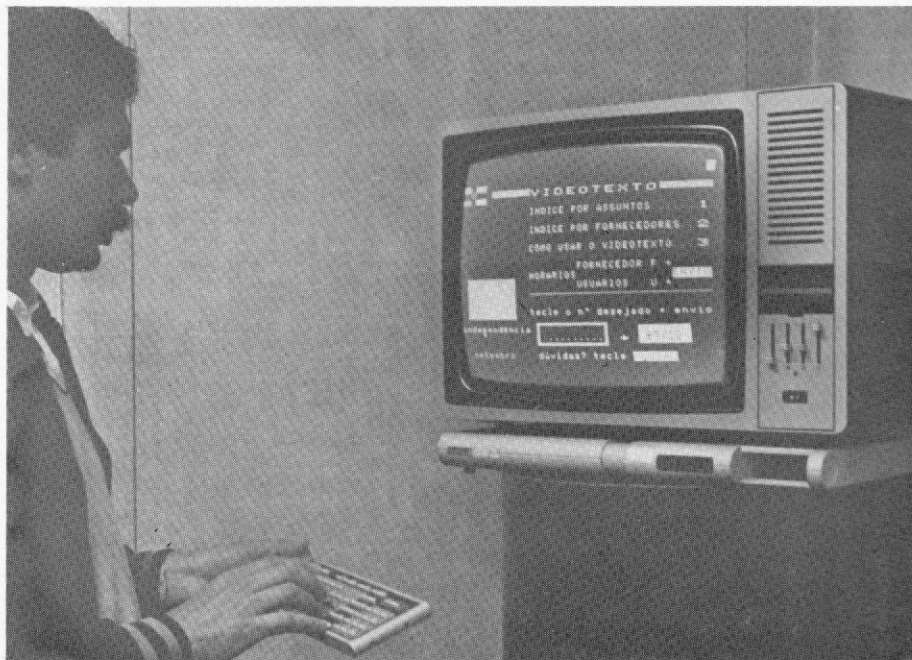
Este é o terminal doméstico do Videotexto. Através do teclado, o usuário tem acesso às "páginas" de seu interesse.
